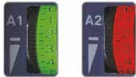
Farbwechsel der Skalenbeleuchtung abhängig vom Schaltzustand
