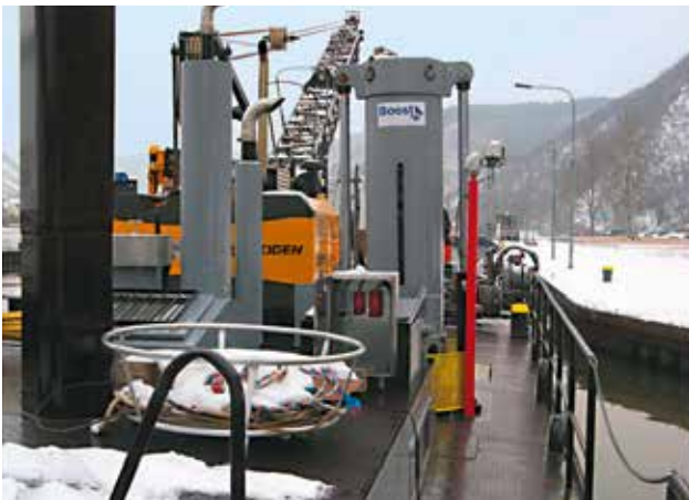
Ankerzylinder eines Baggerschiffes. Der Ausfahrweg des Teleskopankers wird mit einem VHZ von GHM erfasst.
