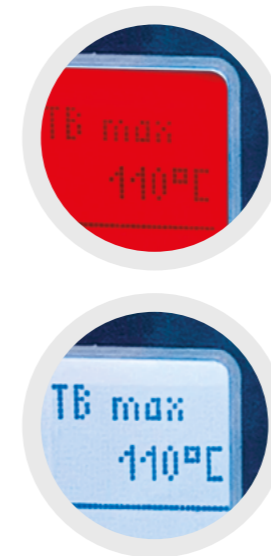
Automatischer Farbwechsel bei Grenz- wertüberschreitung von blau zu rot.
