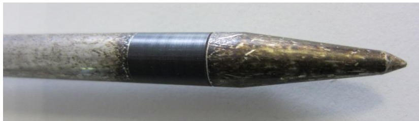
Verunreinigte Elektroden Spitze -> misst falsch!
