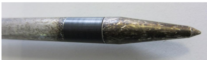
Verunreinigte Elektroden Spitze -> misst falsch!
