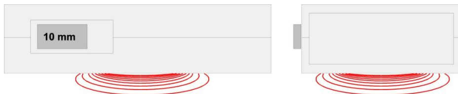
Seitenansicht: Messfeld und Eindringtiefe bei Schalterstellung „10 mm“
