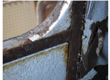
Isolation und Metallrahmen an älterem Wohnwagen
