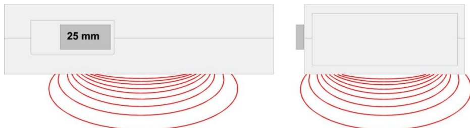
Seitenansicht: Messfeld und Eindringtiefe bei Schalterstellung „25 mm“
