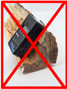
Falsch: Verworfene Oberfläche (hier extrem!)
