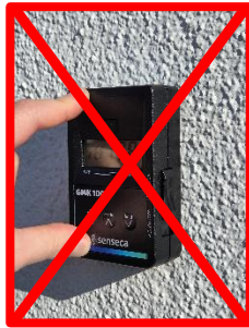
Falsch: unregelmäßige Oberfläche
