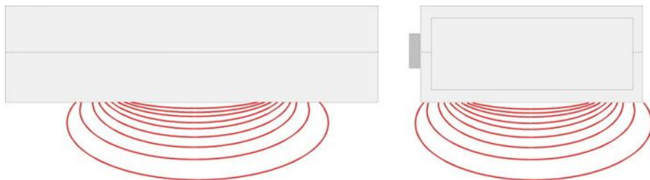
Seitenansicht: Messfeld und Eindringtiefe ca. 25 mm
