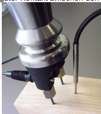
Hohlhammerlektrode GHE 38 mit Temperaturfühler GTF 38
