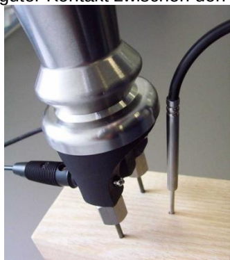
Hohlhammerlektrode GHE 38 mit Temperaturfühler GTF 38
