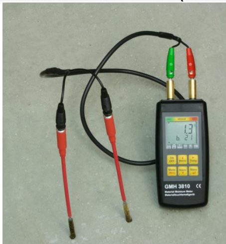
Messung mit Bürstensonnen GBSL91
