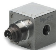
HDP356B20 - accelerometro triassiale per applicazioni HA - Shock, sensibilità, 1mV/g
