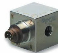
HDP356B21- accelerometro triassiale per applicazioni HA, sensibilità 10 mV/g
